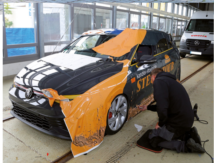
Die 3M Print Wrap-Folie IJ 280 wurde trocken verklebt.
