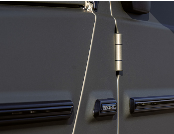
Am schwierigsten zu folieren an der G-Klasse waren die Scharniere.
